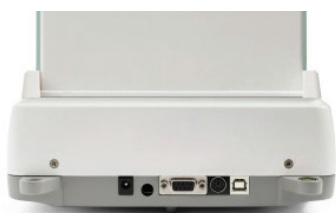
Un'immagine del retro della bilancia che mostra: gancio anti-furto, connettore alimentatore, porta RS232, porta PS2, porta USB e bolla d'aria.
